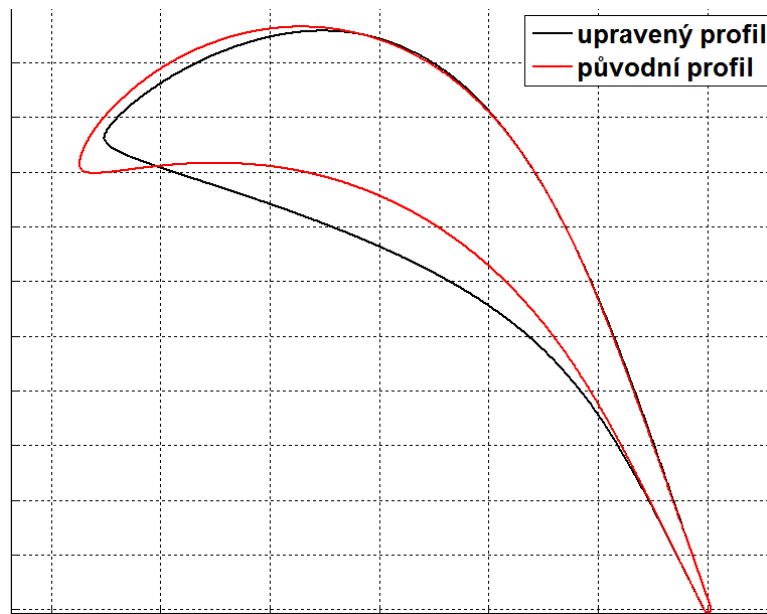
Obrázek 30 – Srovnání středových řezů profilů původní a upravené oběžné lopatky
