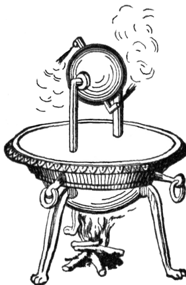
Obrázek 1: Heronova baňka (Aeolipile) [17]
