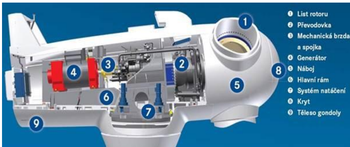
Obrázek 10 Řez strojovnou větrné elektrárny [14]
