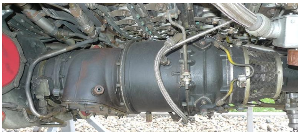
Obr. 2 – Fotografie namontovaného TS-21 2
