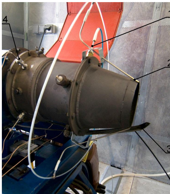
Obr. 32 - Tlakové sondy ve výstupní soustavě 33
