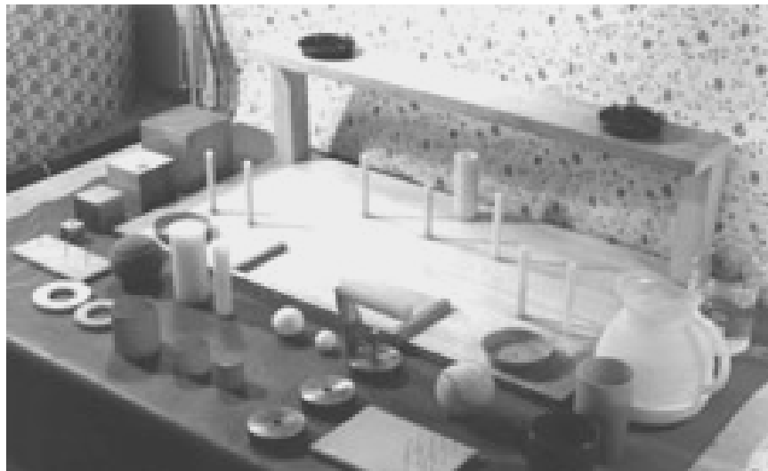
Testovací deska pro úchopový funkční test
