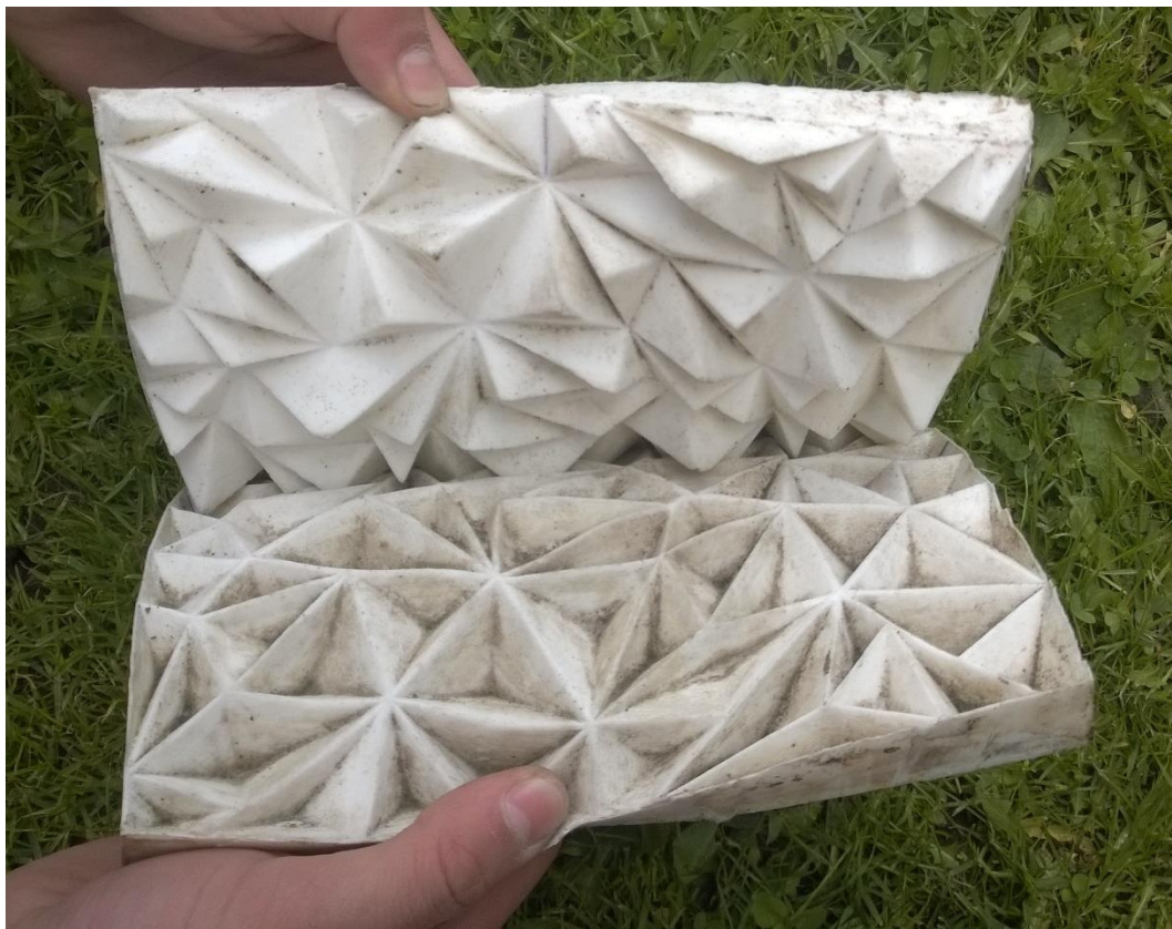
Obrázek 27 - Silikonová forma, oddělení po odlití
