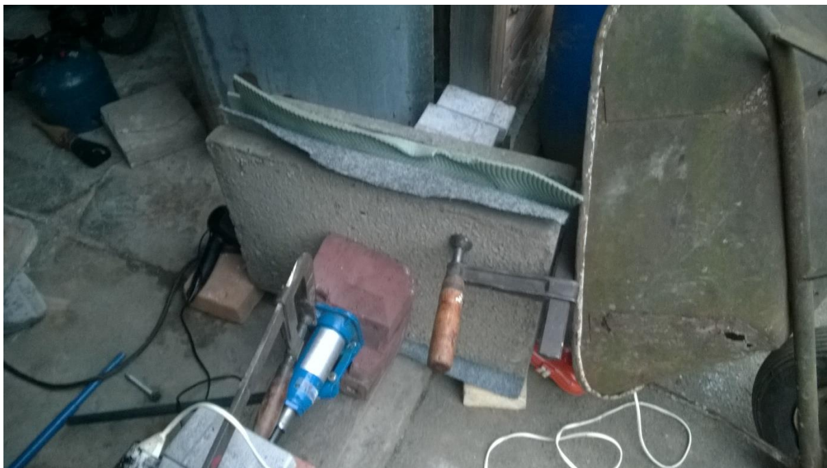
Obrázek 36 - Lisování hydraulickým heverem
