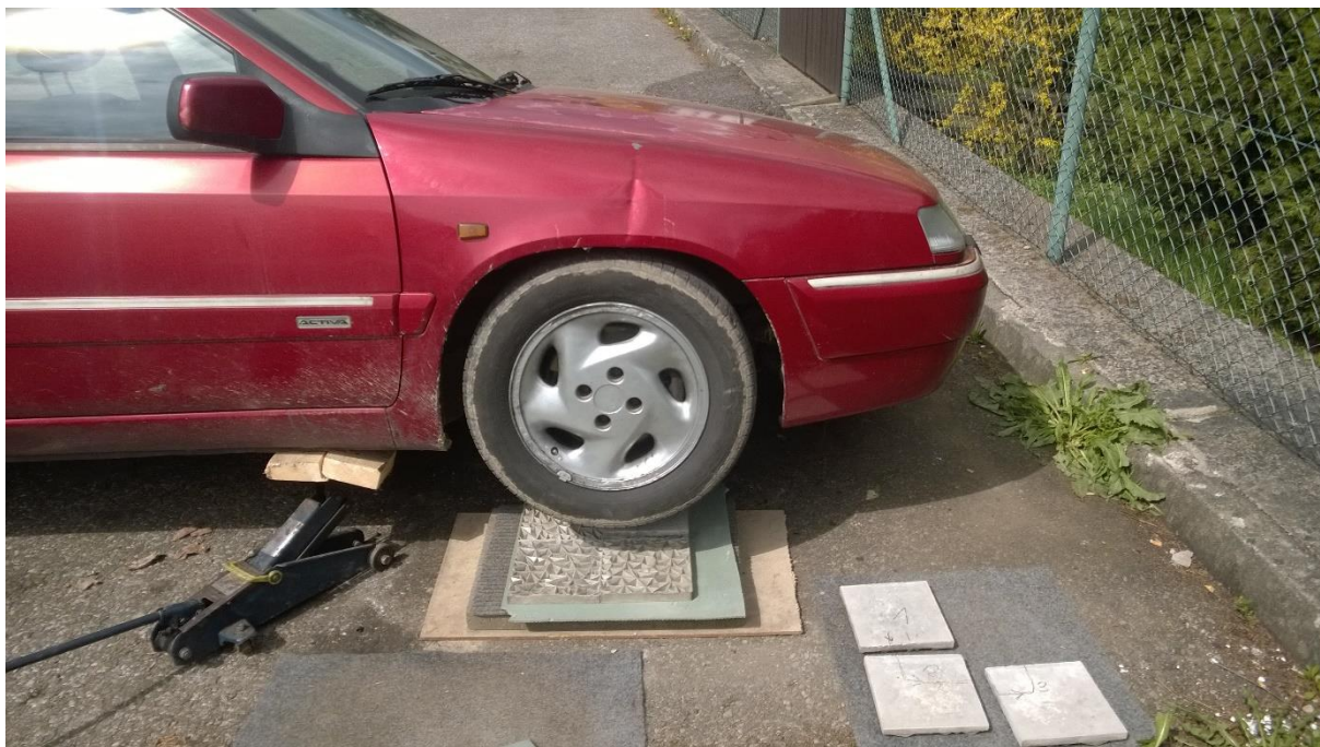
Obrázek 34 - Příprava lisování dezénu pod autem
