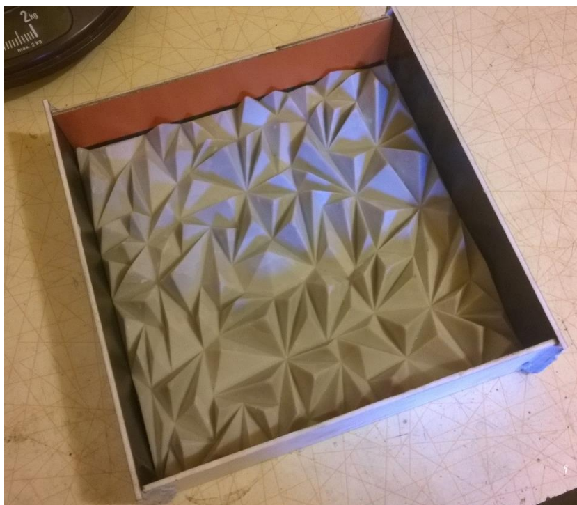
Obrázek 26 - Forma 3D tisk, připravena k odlití
