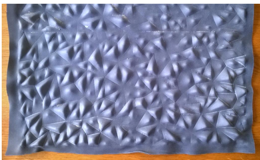
Obrázek 39 - Vylisovaný dezén v kůži, detail
