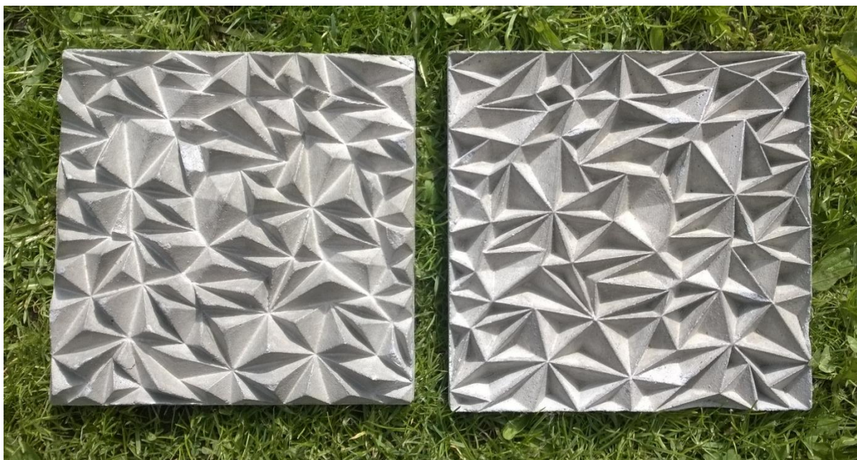
Obrázek 31 - Betonové formy pozitiv a negativ
