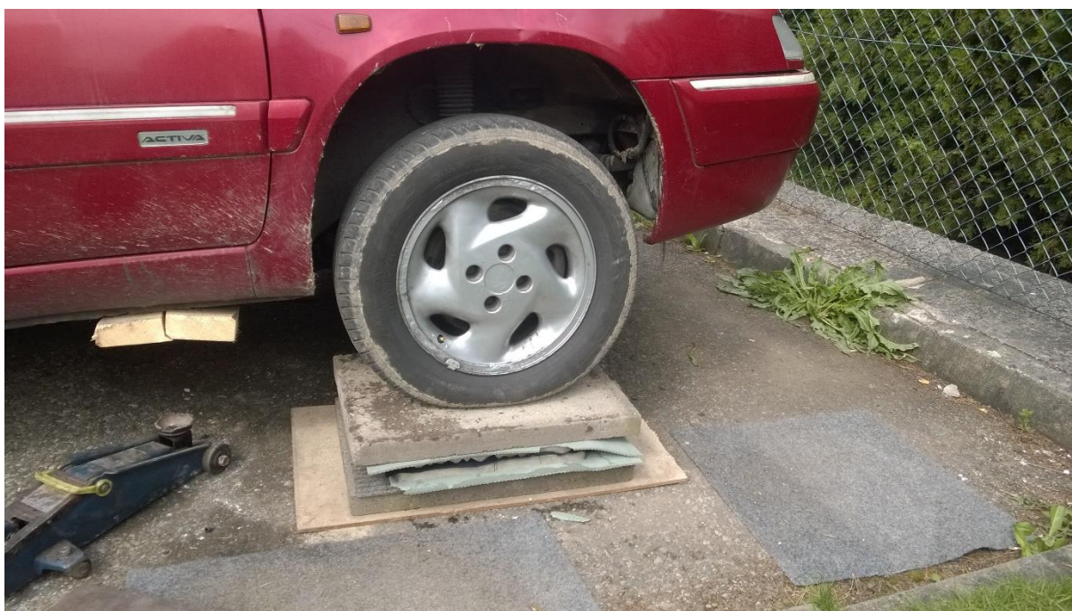
Obrázek 35 - Lisování dezénu pod kolem auta
