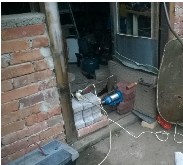
Obrázek 37 - Lisování hydraulickým heverem v síle zdiva
