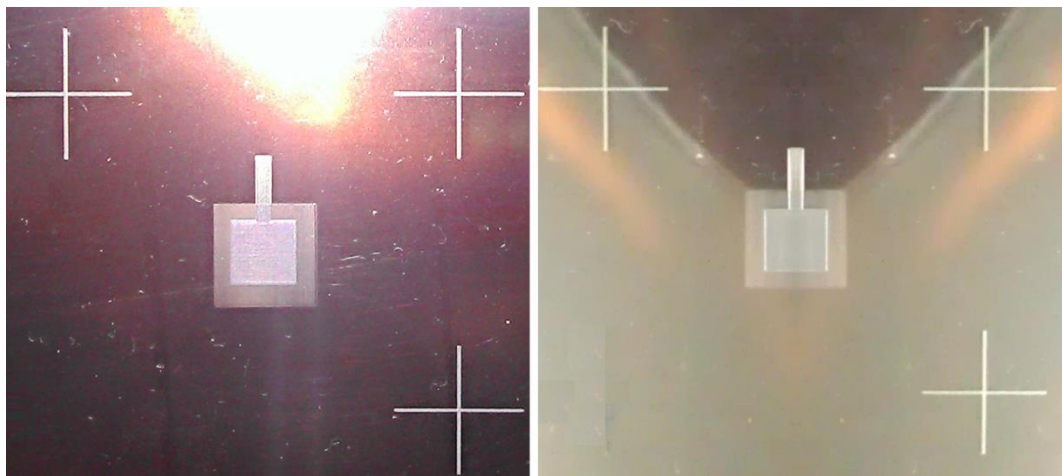
Obr. 3.6: Detail natištěných dielektrik kondenzátorů na Kaptonovém a PET substrátu.
