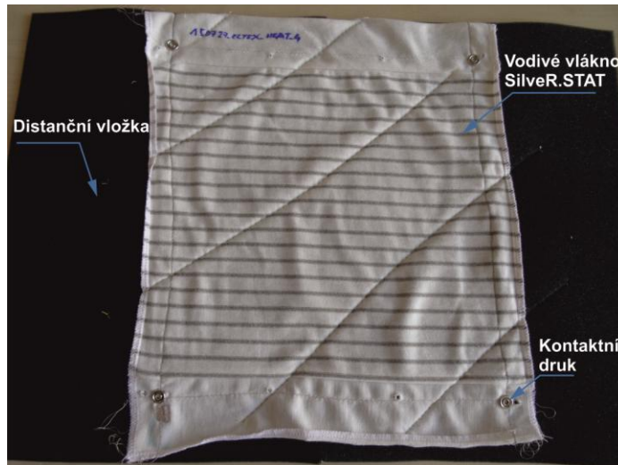
Obr. 4.2 3 – vrstvý kapacitní snímač
