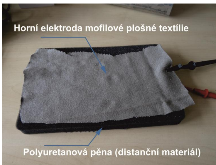
Obr. 4.1 Kapacitní snímač z monofilové plošné textilie
