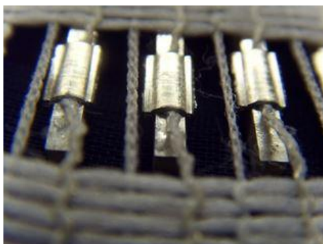
Obr. 2.3 Izolovaný vodič integrovaný do textilie, převzato [4]
