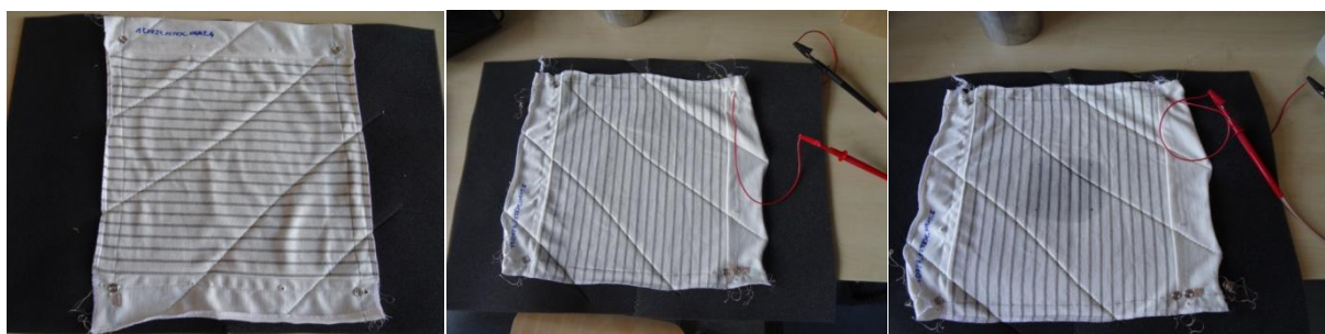
Obr. 9.2 Fotografie z měření 3 – vrstvého kapacitního snímače
