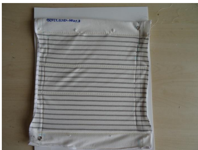
Obr. 4.4 Tenzometrický snímač přítomnosti
