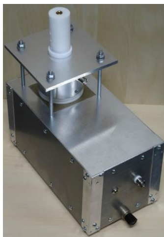
Obr. 6: Kompletní konstrukce diagnostické jednotky Tab. 1: Shrnutí základních komponent PEA jednotky
