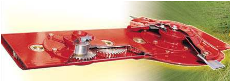
Obrázek 12 Řez rámem a součástí Mähscheibe Zdroj[8]
