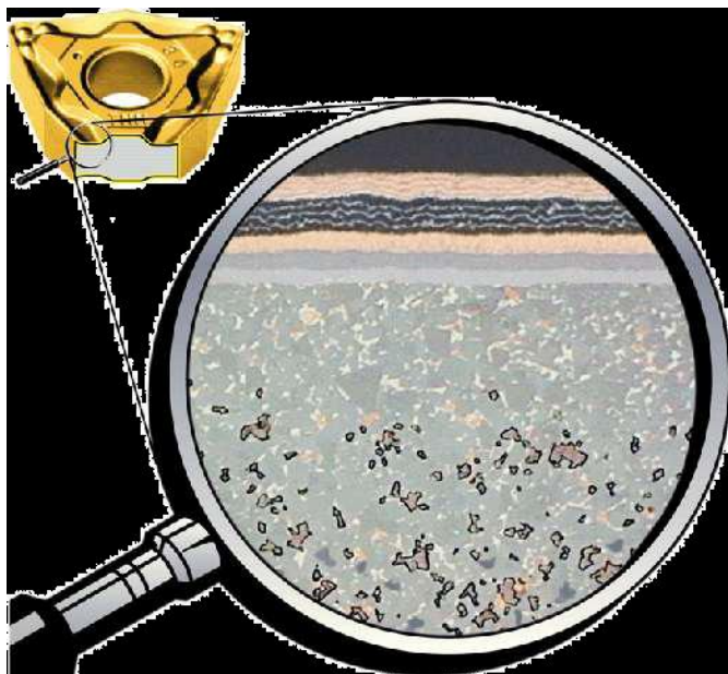
obrázek 1: Systém tenká vrstva- substrát[9]
