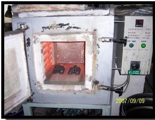
obrázek 9: Pec pro nitridaci[18]
