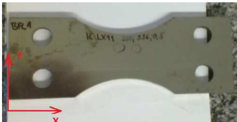
obr. 49 směry měření parametru drsnosti
