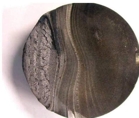
obr. 17 korozní úrava nástrojové oceli [21]
