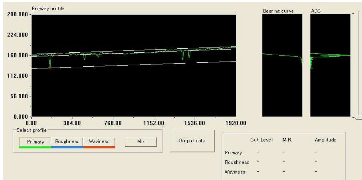
obr. 69 BL3 profil, patrné lokální prohlubně od rýh
