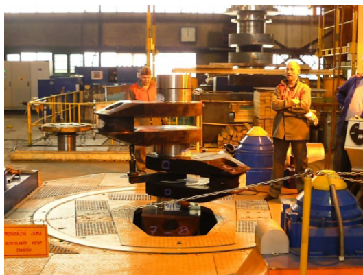
Obrázek 2.6: Sestavování zalomené hřídele
