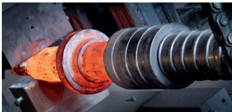
Obrázek 2.4: Kování čepu zalomeného hřídele
