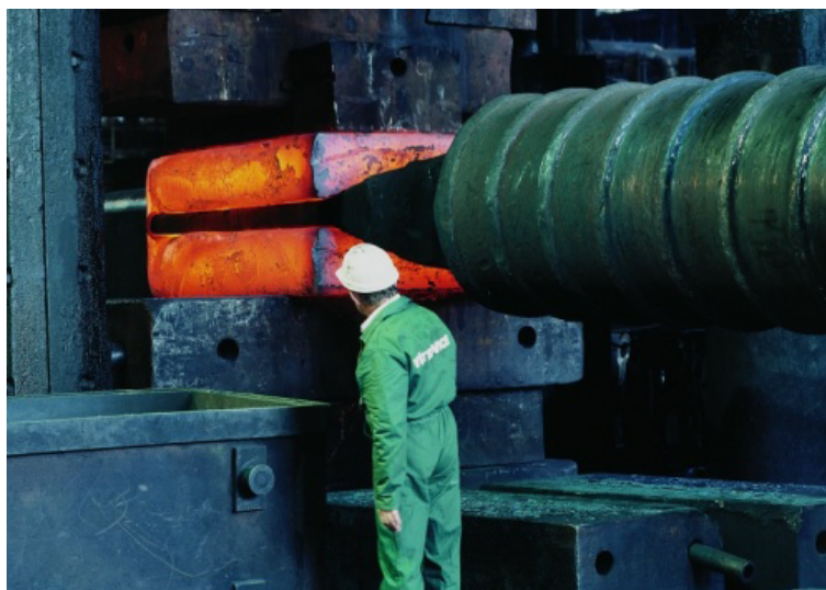
Obrázek 2.3: Kování středního kusu zalomené hřídele
