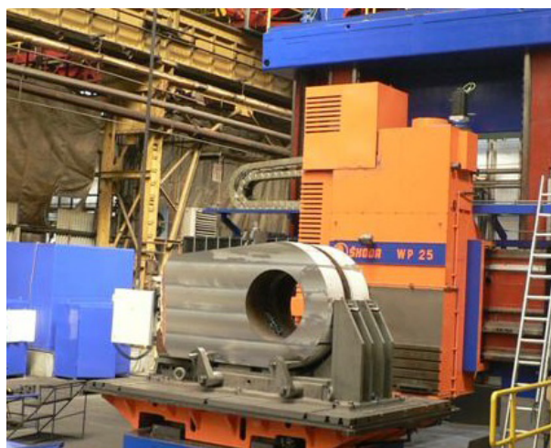
Obrázek 2.5: Opracování středního kusu zalomeného hřídele
