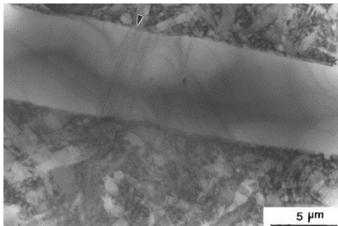
Obrázek 8 – Šipka ukazuje na hranovou dislokaci u SiC struktury [11]
