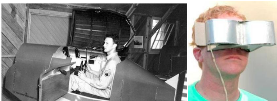
Obr. 4 Vlevo první letecký simulátor Link Trainer, vpravo první virtuální brýle Telesphere Mask [12]
