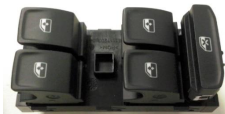
Obrázek 5-2: Ovládací panel na stahování oken s pěti spínači
