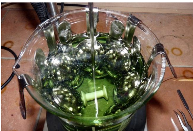
Obr. 4.5 Rovnoměrné rozmístění přípravků v roztoku, ve středu obrázku je vidět elektromagnetická míchačka a ponořený teplotní senzor.
