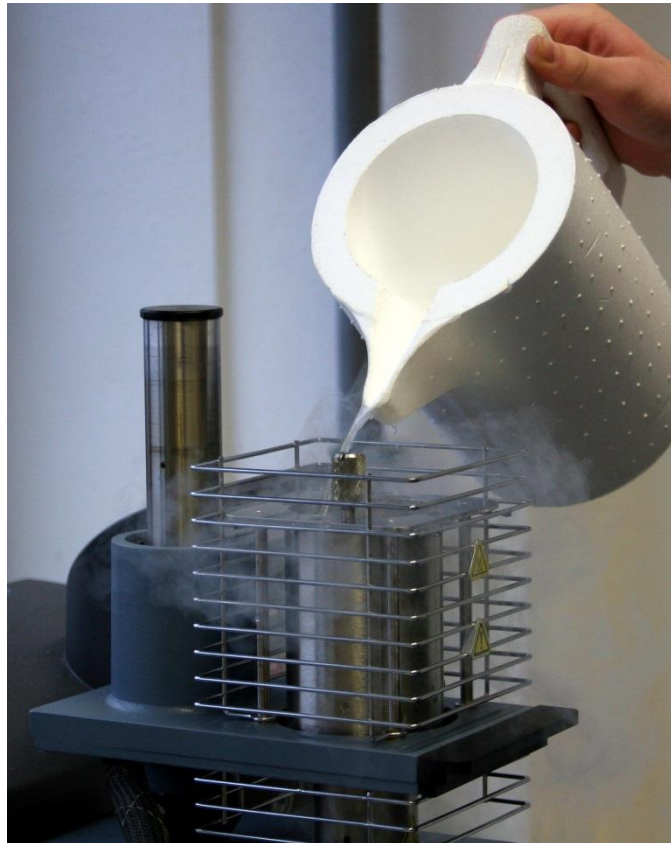
Obr. P.33 Ochlazování aparatury TMA Q400EM od firmy TA Instruments pomocí tekutého dusíku.
