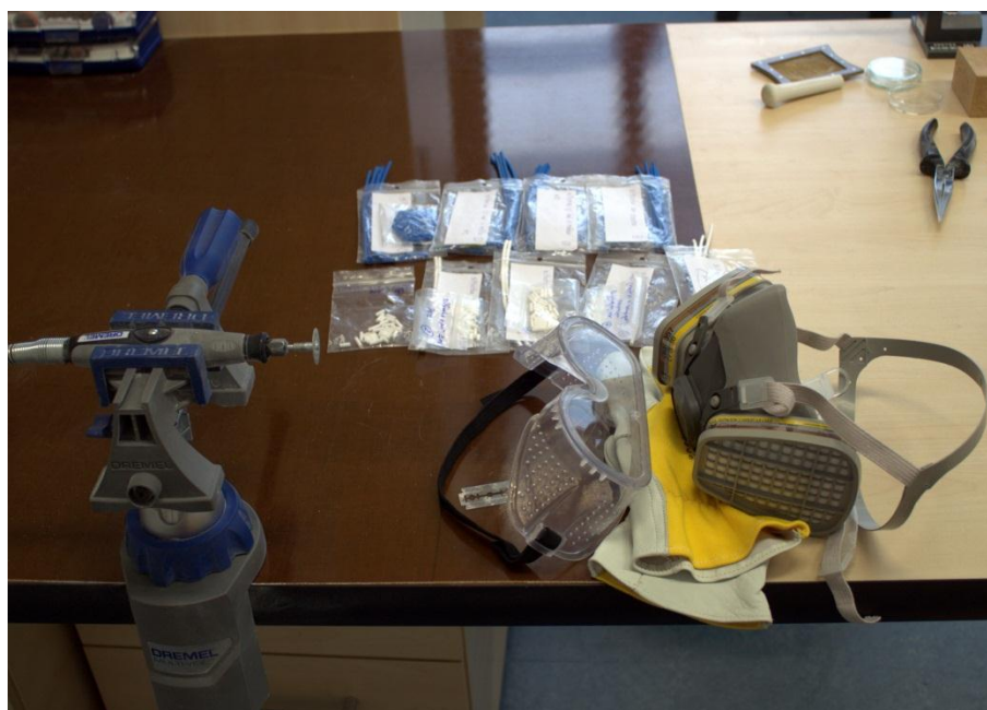
Obr. P.32 Pracoviště s pomůckami pro přípravu vzorků pro měření na TMA Q400EM.
