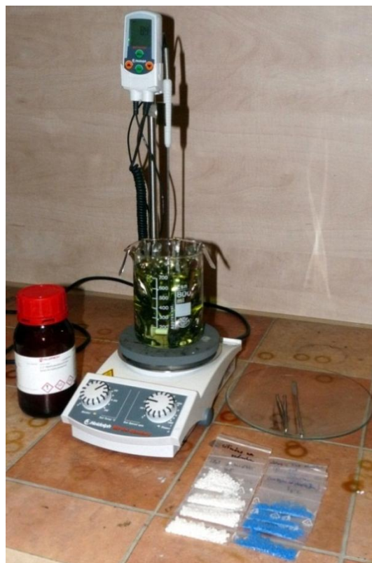
Obr. 4.4 Aparatura pro extrakci vzorků.
