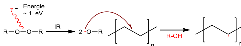
Obr. 2.6 Reakční schéma přípravného roubování PE peroxidy. [56]
