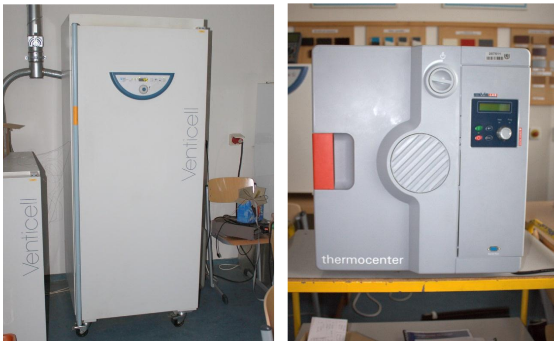
Obr. P.31 Pece použité při měření metodou hot set test, při vysoušení zkušebního materiálu a přípravků pro extrakční metodu; vlevo Venticell, vpravo Salvis LAB Thermometer.
