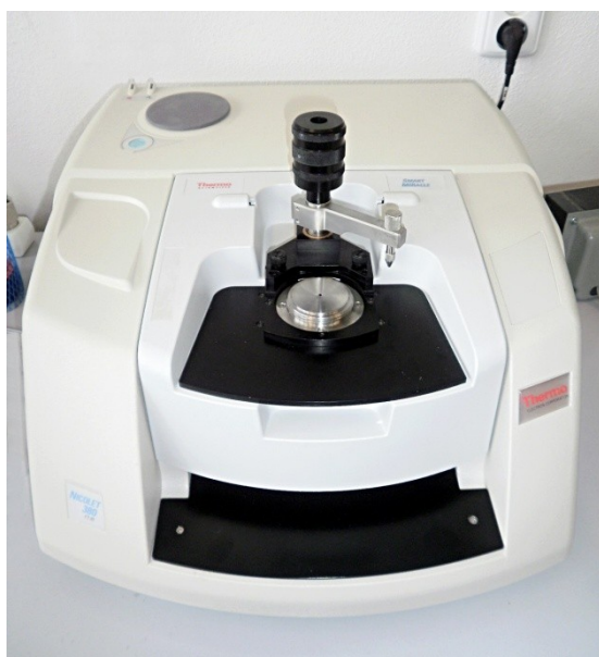
Obr. 16: FT-IR spektroskop Nicolet 380 s ATR nástavcem
