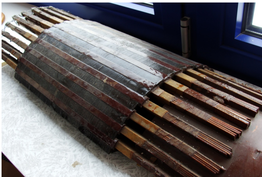
Obr. 3.1: Část statoru elektrického motoru, kde je použita jako hlavní izolace vodičů technologie Resin-Rich.
