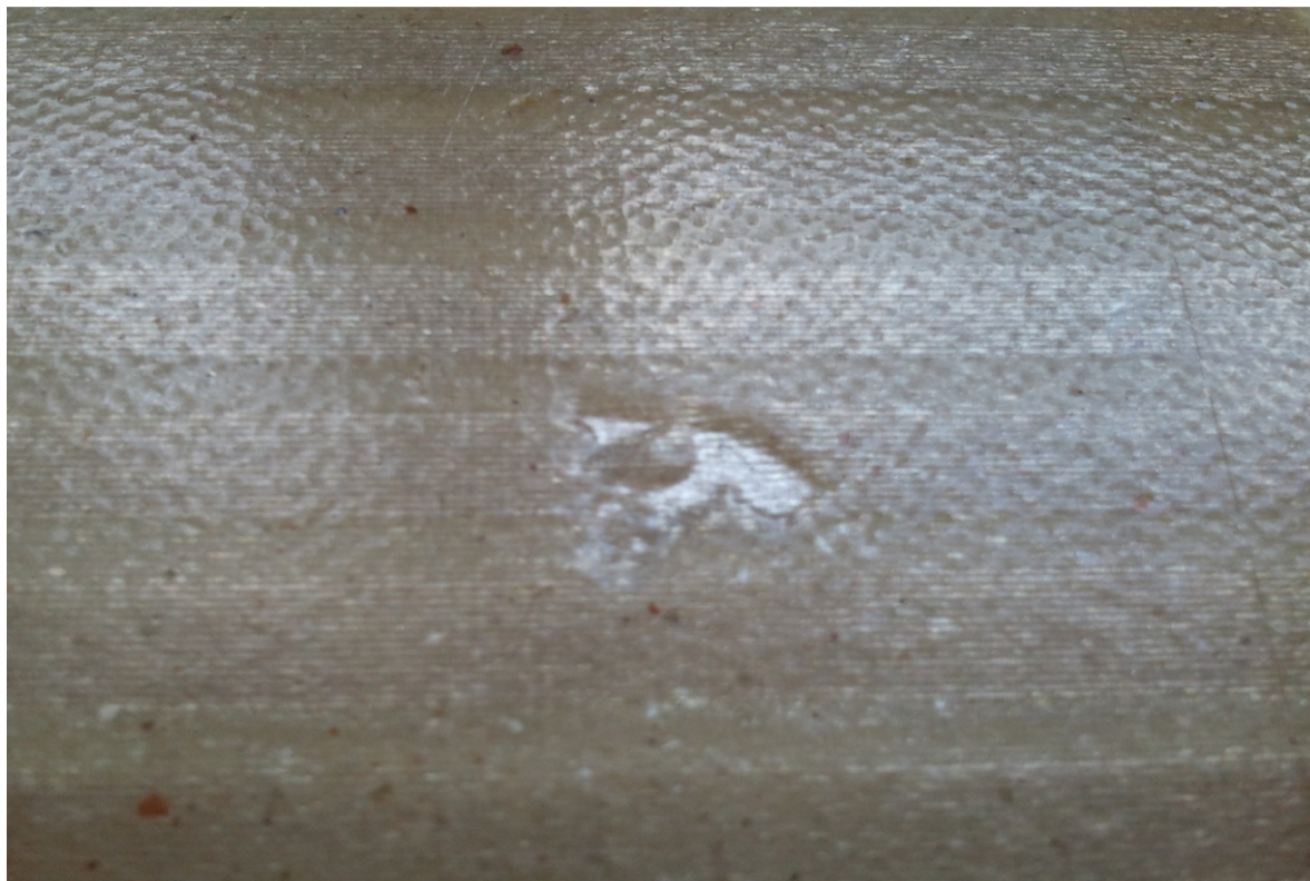
Obr. 6.1: Narušený povrch elektroizolačního materiálu.
