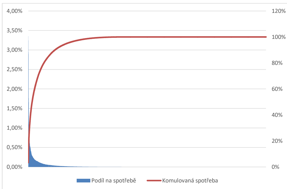
Obrázek č. 31 Podíl jednotlivých náhradních dílů na spotřebě v roce 2016 a Lorenzova křivka (kumulativní četnosti) spotřeb
