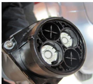
Obr. č. 30: JEVS G105-1993 / CHAdeMO Tepco konektor [27]
