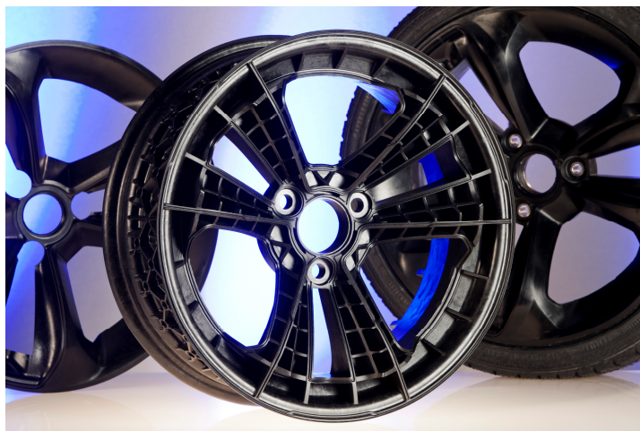
Obr. č. 40: Celoplastové disky kol firmy Basf 25
