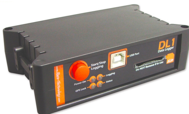
Obr. č. 56: Datalogger Race Technology DL1 MK3 36
