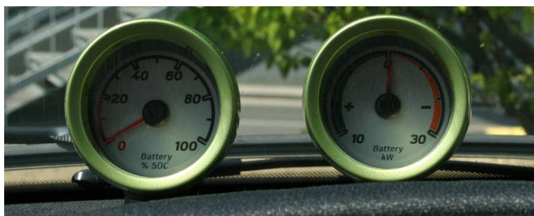
Obr. č. 58: Palubní ukazatele toku výkonu a stavu nabití baterie
