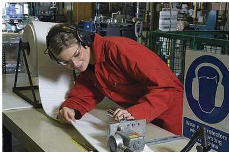
Obr. č. 4 – Používání ochranných pomůcek spolu s výstražným značením [12]
