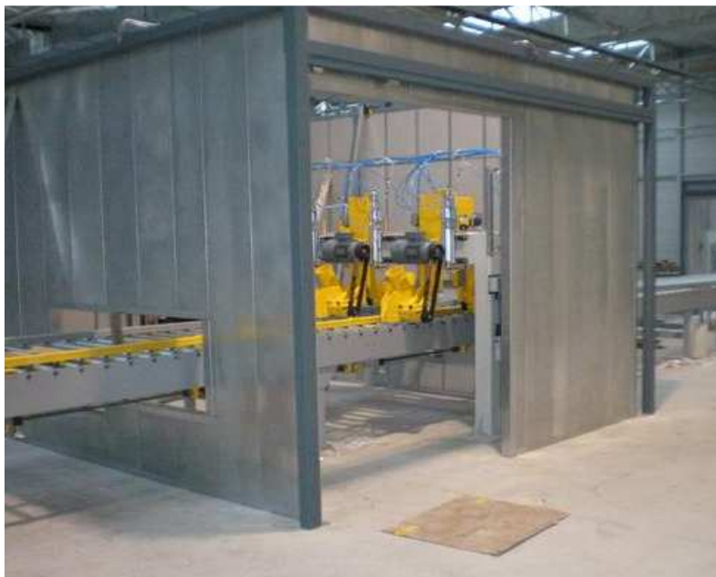
Obr. č. 2 – Izolační kryt výrobního stroje s možností přístupu [16]
