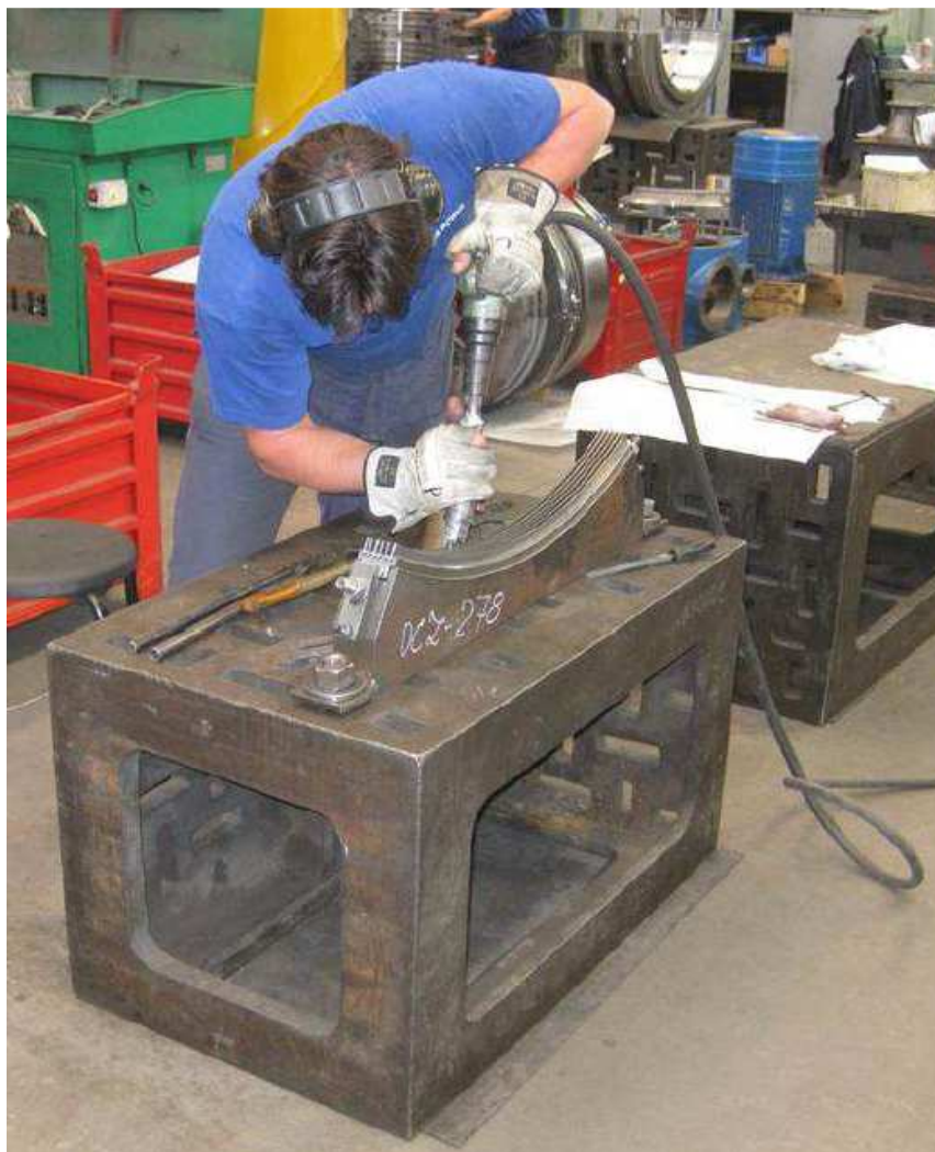
Obr. č. 5 – Pracovník během rozklepávání labyrintových plechů
