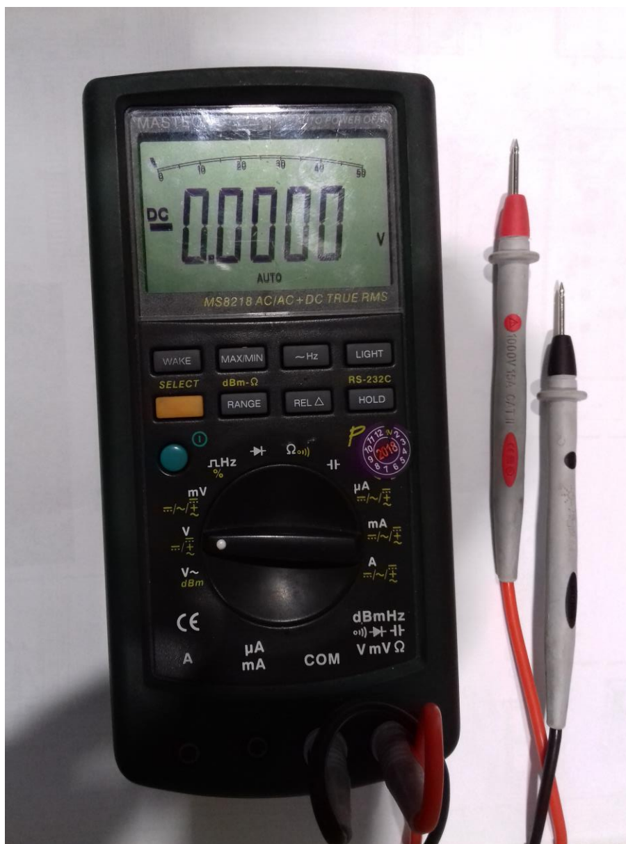
Obr. 18 - Multimetr MASTECH 8218 – měření napětí U_{nbat}
