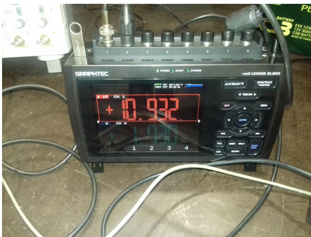
Obr. 17 - Dataloger GRAPHTEC GL900 během měření - vzorkování 2s [17]
