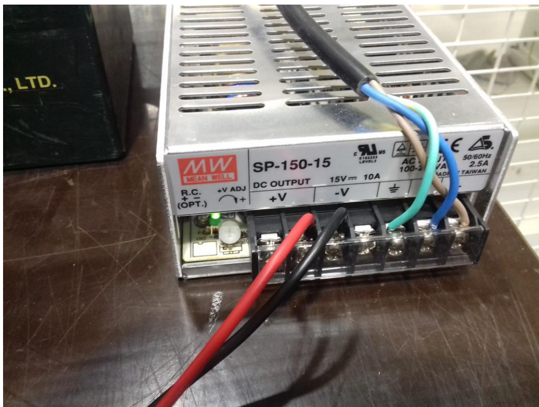
Obr. 19 - Štítek napájecího zdroje MEAN WELL 15V DC / 150W [19]
