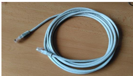
Obr. 33 Datový kabel s RJ45 konektorem
