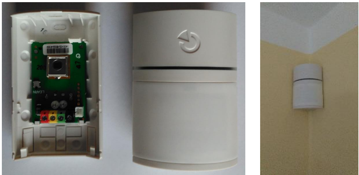
Obr. 8 a) čidlo PIR JABLOTRON JA-111P, b) příklad instalace PIR čidla
