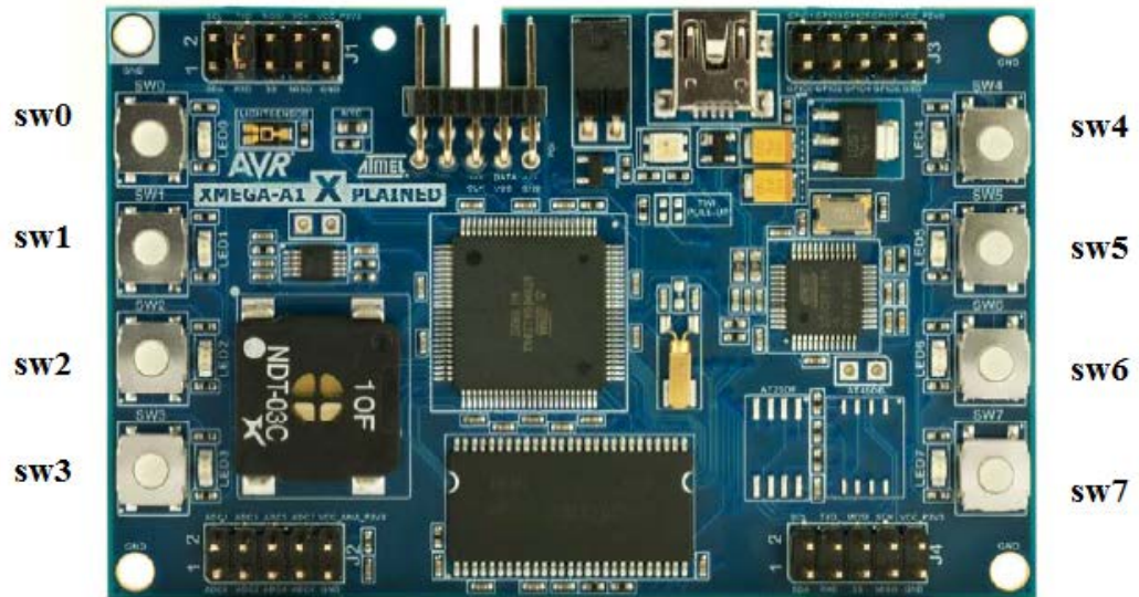
Obr. 28. Vývojový kit s popisem tlačítek, převzato a upraveno z [18]
