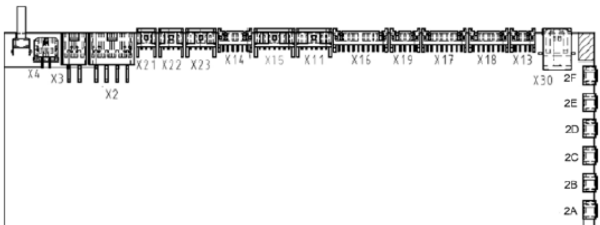
Obr. 3.5 Schéma svorkovnic ovládací konzole CTM pro připojení podsystémů [14]
