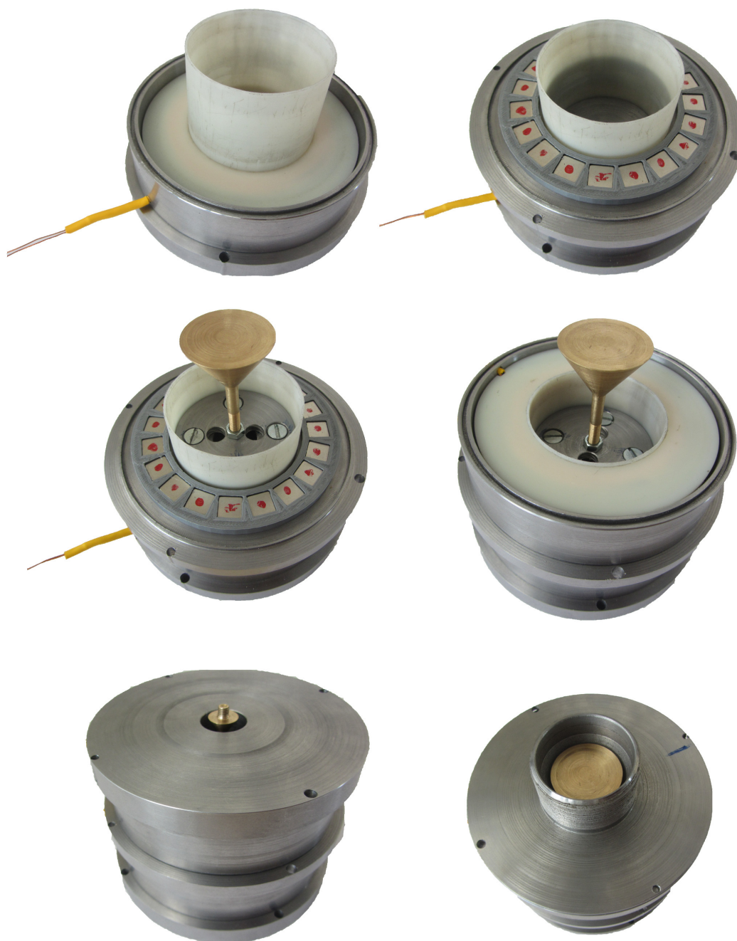
Obr. 31: Fotografie postupného skládání prototypu ventilu
