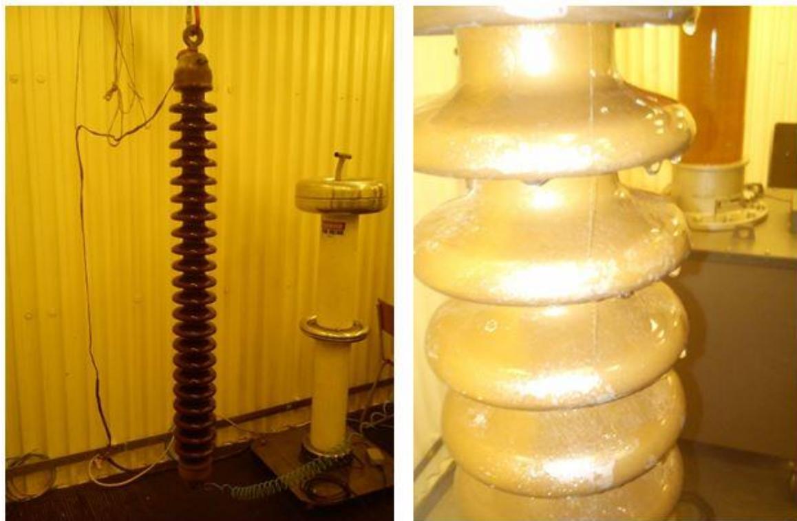
Obrázek 41: 1,2 m dlouhý izolátor LG 60/22/1200, vpravo detail na zachycenou pavučinu
