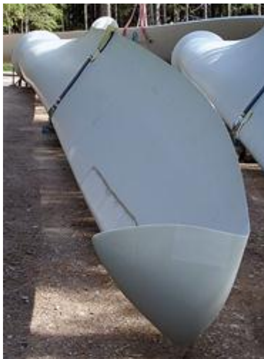
Obr 1.8: Rotorový list zakončený wingletem [7]
