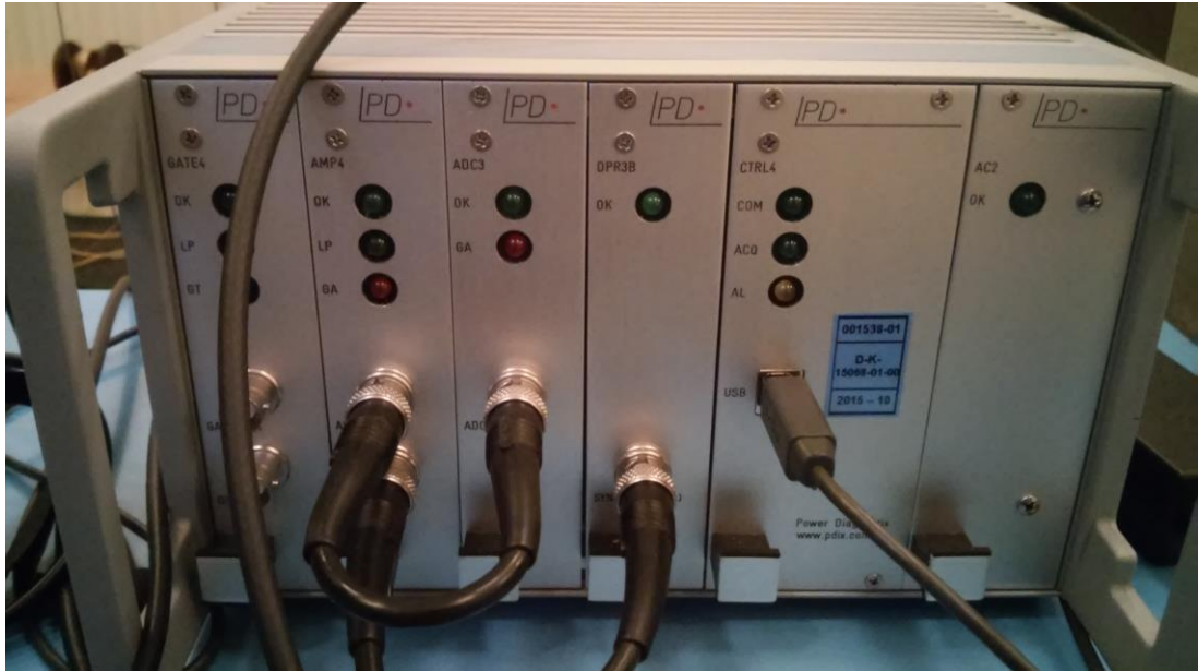
Obr. B.2: Detail detektoru částečných výbojů od výrobce PD: Hlavní zesilovač, měřič výbojů, měřič napětí a převodník pro výstup na PC
