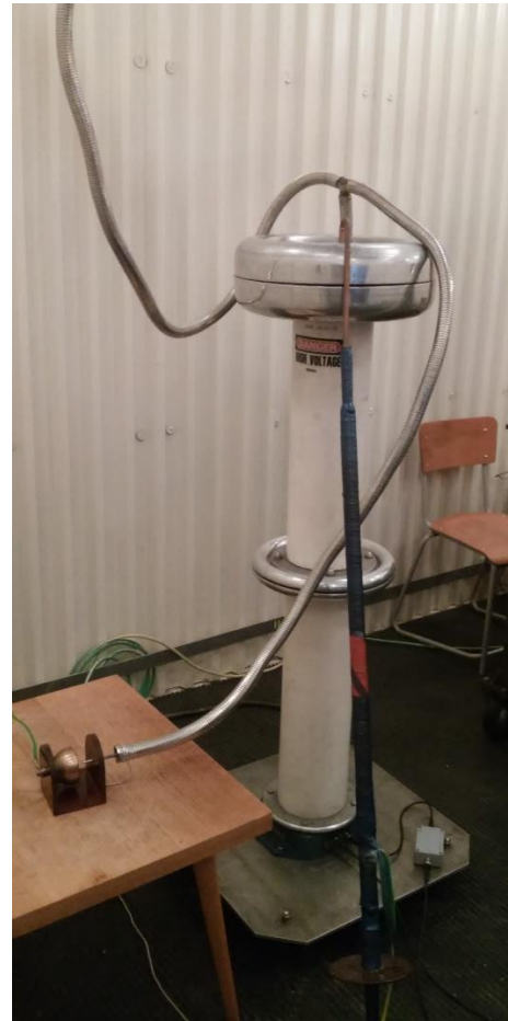
Obr. B.3 (vlevo): Vazební jednotka do 25 kV pro DC měření na DČV
