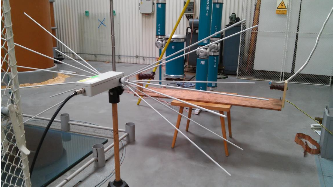
Obr. C.1: Měřicí uspořádání pro měření bikónickou anténou BC-01 výrobce PMM (vpředu) na modelu vodič- deska (v pozadí)
