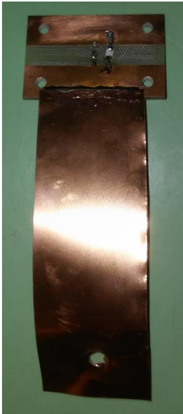
Obr. A.3 (vlevo): Bezindukční odpor pro převod proudu na měřitelné napětí s přípojným páskem
