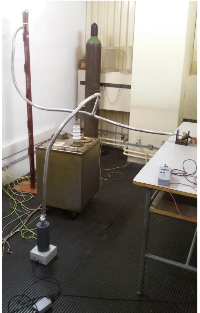
Obr. B.5 (vlevo): AC zdroj vysokého napětí pro měření částečných výbojů
