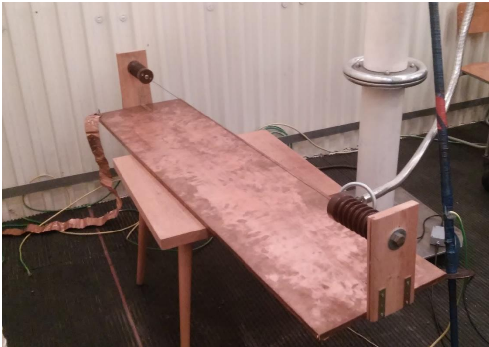
Obr. A.1: Model vodič-deska připojený do obvodu
