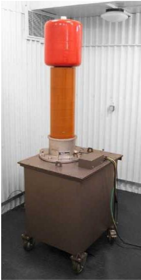
Obr. B.5 (vlevo): AC zdroj vysokého napětí pro měření částečných výbojů
