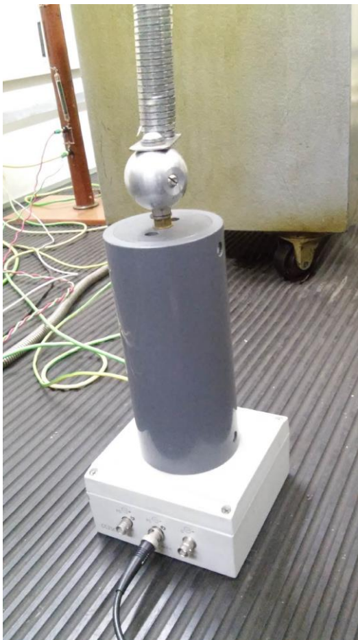
Obr. B.3 (vlevo): Vazební jednotka do 25 kV pro DC měření na DČV
