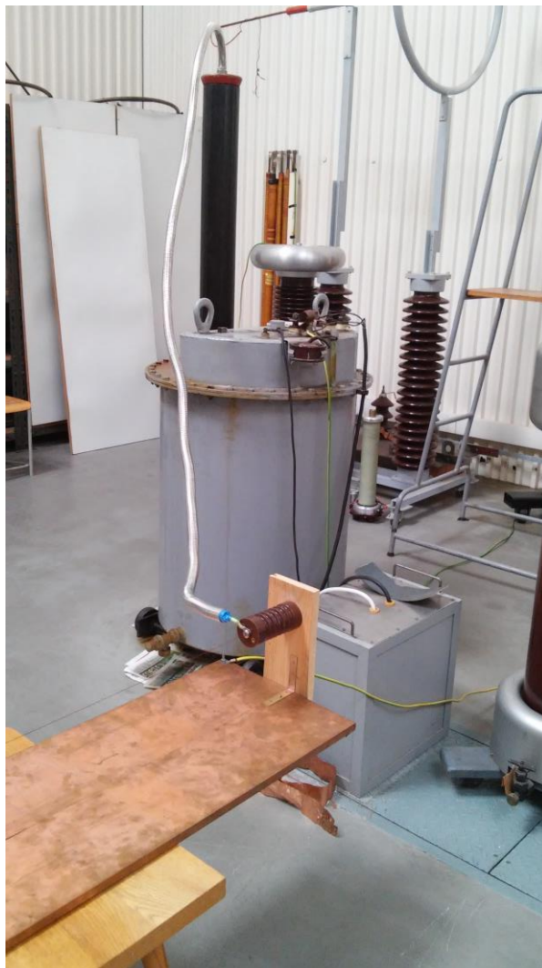
Obr. C.2: AC zdroj VN použitý při měření anténou
