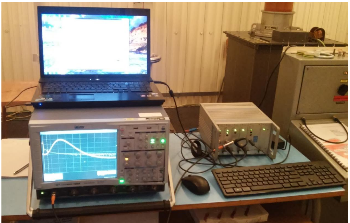
Obr. B.1: Stanoviště pro měření částečných výbojů na AC: osciloskop a PC (vlevo), DČV (vpravo)
