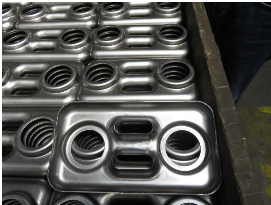
Obr. 41 Vylisované hlavy v dřevěném kontejneru
