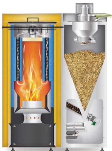
Obr. 4: Vizualizace řezu automatického kotle na pelety (převzato z [3 O])
