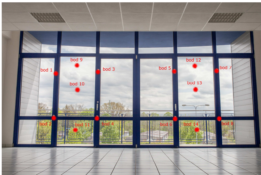
Obr.: 30 - Konfigurace měřených bodů na solárním okně v EU3
