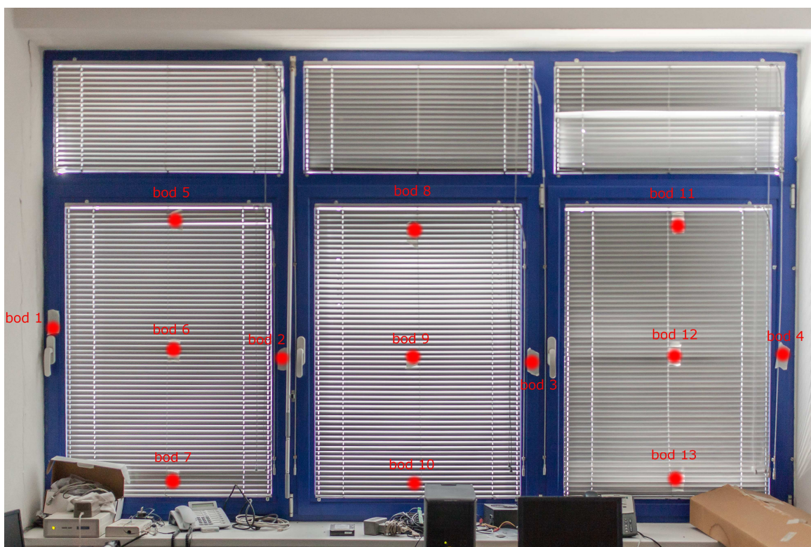
Obr.: 33 - Konfigurace měřených bodů na solárním okně v místnosti EL703
