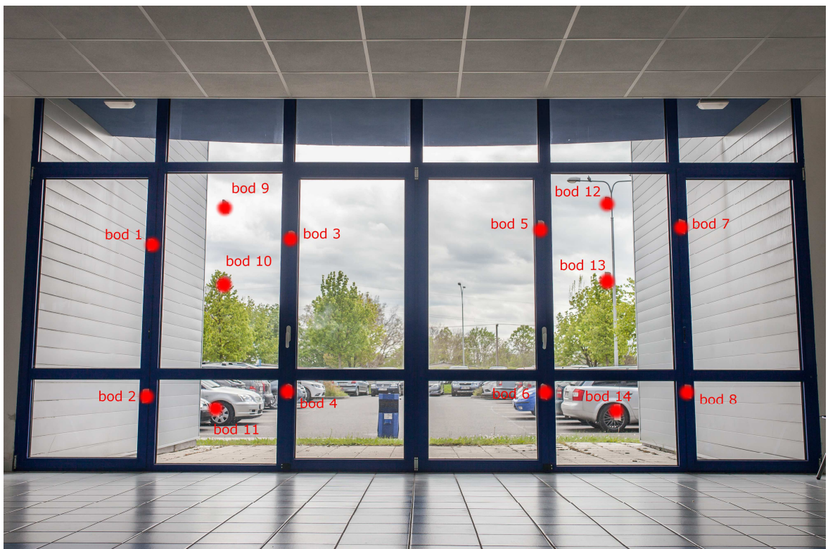
Obr.: 28 - Konfigurace měřených bodů na solárním okně v EU1
