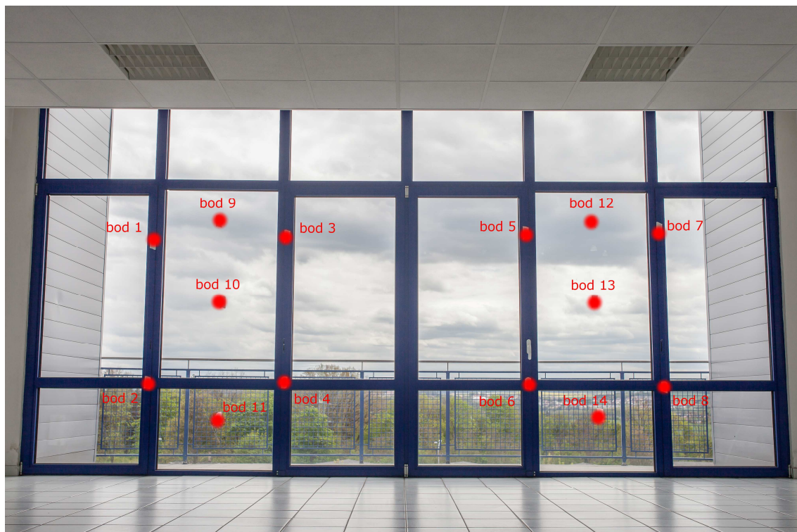
Obr.: 31 - Konfigurace měřených bodů na solárním v okně v EU5
