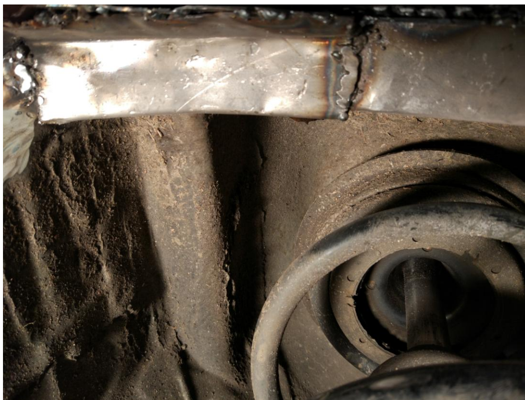
Obrázek 22 - Detailně zachycená tepelně ovlivněná oblast
