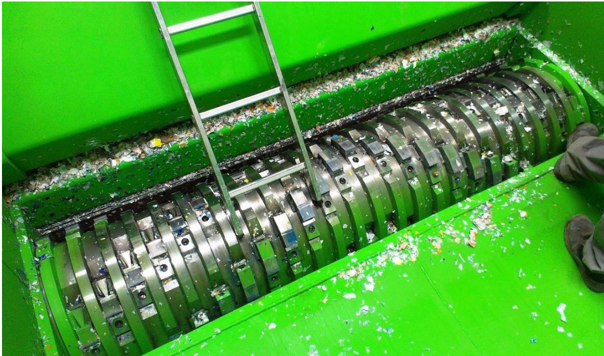
Obrázek 8 - Pracovní prostor drtiče DRJ 2400 [8]
