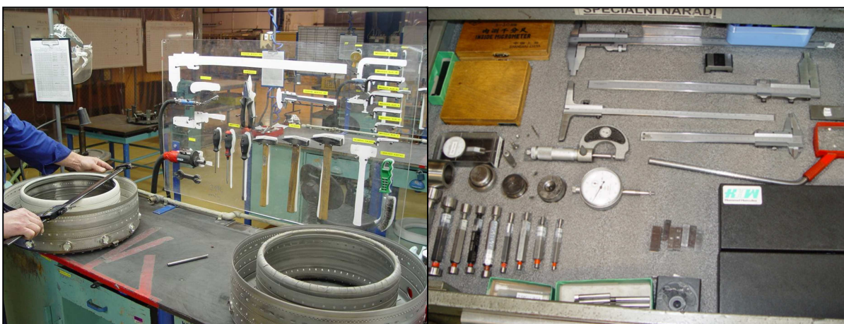
Obr. 38 Shadowboard – plastový (vlevo) a pěnový (vpravo) [16]
