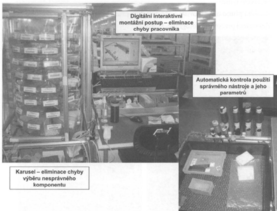
Obr. 12b Chybuvzdorné pracoviště montáže polotovarů [7]
