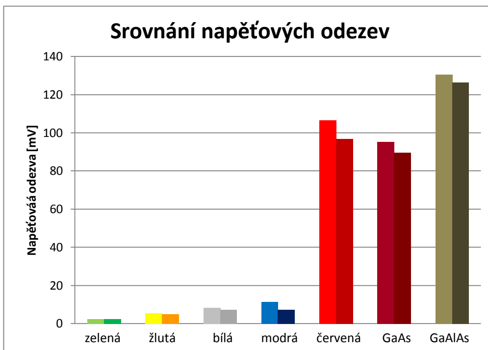
Graf 1: Zobrazení proudových odezvy při porovnání průměru štěrbin (světlejší odstín - Ø1mm, tmavší odstín - Ø0,5mm)
