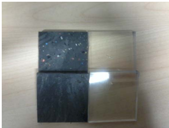
Obr. 24: Zkušební vzorky pro měření stlačitelnosti
