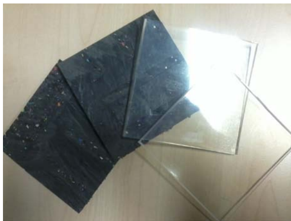
Obr. 23: Zkušební vzorky pro měření elektrických vlastností
