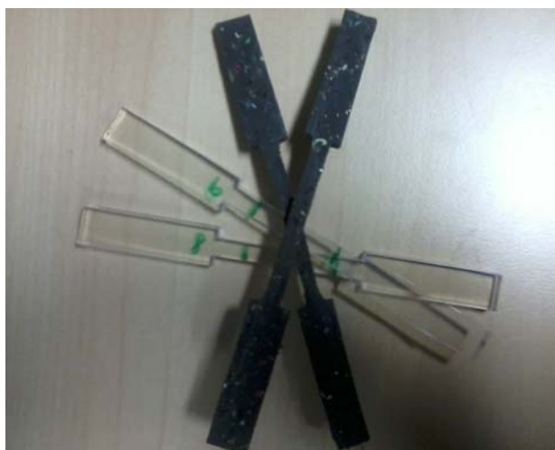
Obr. 25: Zkušební vzorky pro měření meze pevnosti v tahu
