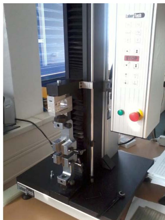
Obr. 27: Přístroje Labor Tech pro měření stlačitelnosti a meze pevnosti v tahu
