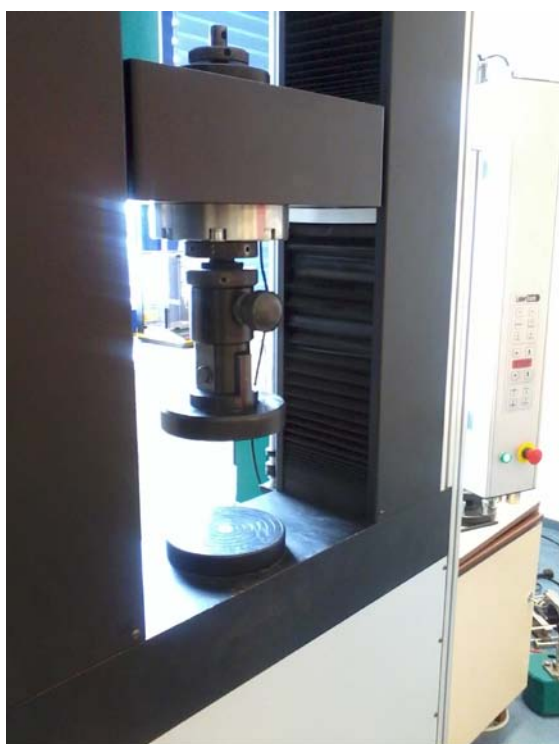
Obr. 27: Přístroje Labor Tech pro měření stlačitelnosti a meze pevnosti v tahu
