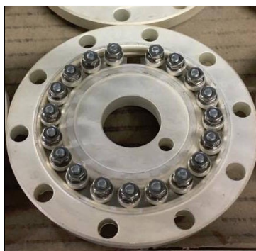
Obr. 6-4: Převod proudu – tzv. kytka
