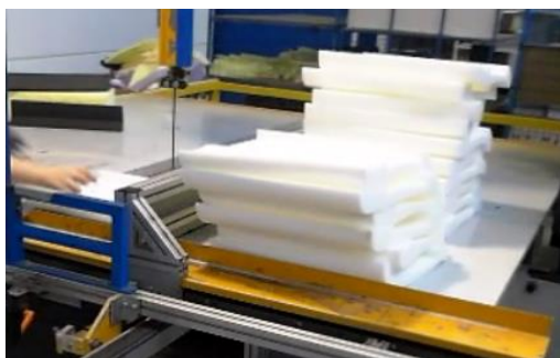
Obrázek 6-5: Kusy po formátování
