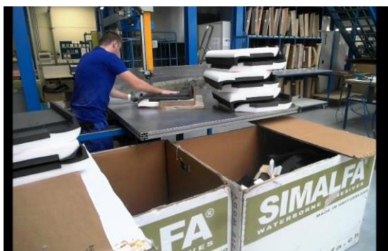
Obrázek 5-11: Ořez na vertikální pile
