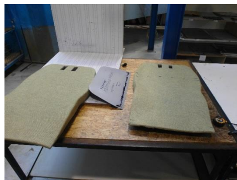
Obrázek 6-16: Vyřezaná okénka v kusu
