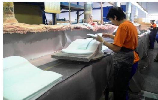
Obrázek 5-10: Ruční lepení dílů
