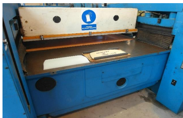
Obrázek 6-11: Lis sloužící k vysekávání
