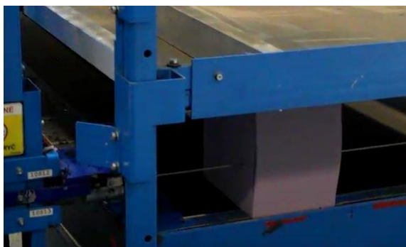
Obrázek 6-3: Pila vyřezávající kusy
