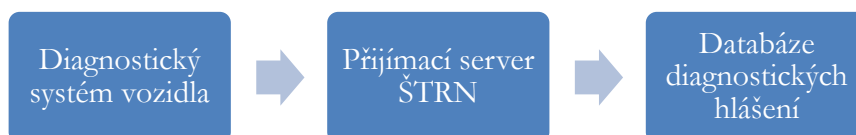
Obrázek 2.3: Přenos dat z vozidla do databáze
