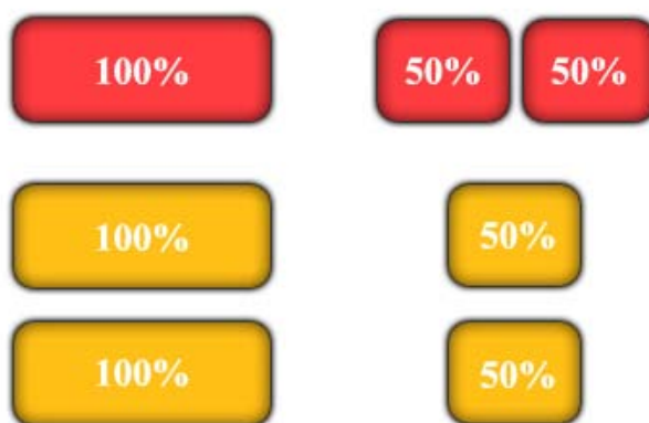
Obr. 2.1 – Metody zálohování 3 x 100% a 4 x 50%
