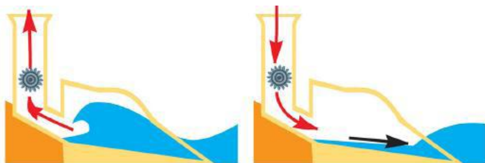
Obr. 11: Princip příbojové elektrárny [14]
