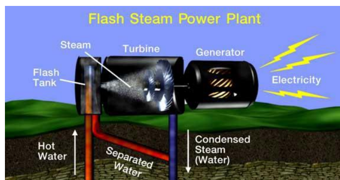
Obr. 25: Schéma geotermální elektrárny na mokrou páru [28]
