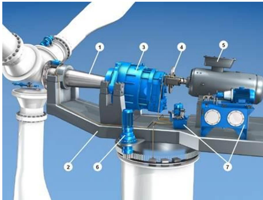
Obr. 31: Vybavení strojovny větrné elektrárny: 1) Hlavní hřídel větrné elektrárny, 2) Nosný rám strojovny, 3) Převodovka větrné elektrárny, 4) Spojení mezi převodovkou a generátorem, 5) Generátor větrné elektrárny, 6) Systém natáčení strojovny, 7) Hydraulické systémy větrné elektrárny [30]
