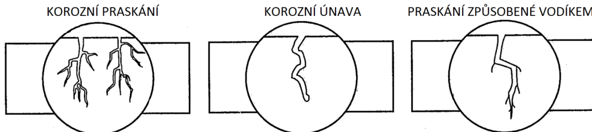
Obr. 13: Schémata prostředím vyvolaných praskání [7]
