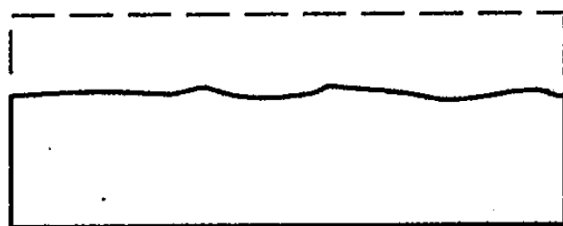
Obr. 9: Schéma rovnoměrné koroze [7]
