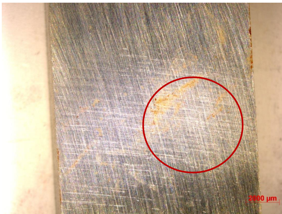
Obr. 43 Výsledek expoziční zkoušky vzorku T552 TZ1.
