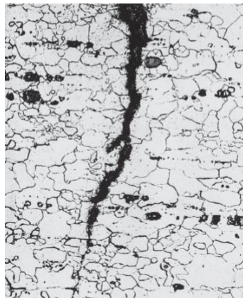
Obr. 10 Transkrystalická trhlina v ocelovém plechu zatěžovaném na tah [7].
