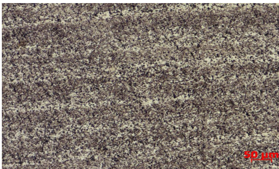
Obr. 3: Struktura rychlořezné nástrojové oceli ve válcovaném stavu
