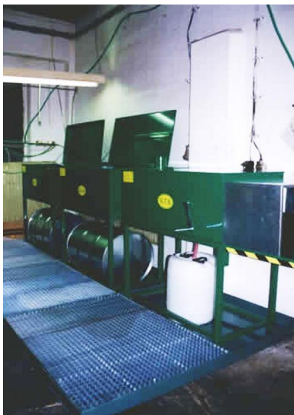
Obr. 17 Odmašťovací pracoviště s mycí, oplachovou a sušící vanou (firma QTS) [19]
