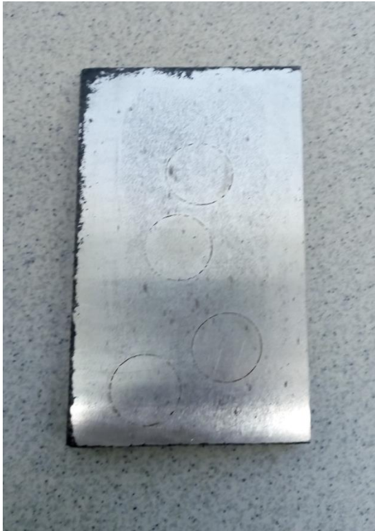
Obr. 46 Viditelné stopy koroze na vzorku z litiny B11
