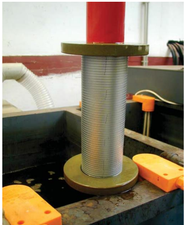
Obr. 12 Tvrdé chromování pístních kroužků navlečených na chromovací trn v Buzuluku Komárov, a. s. [11]
