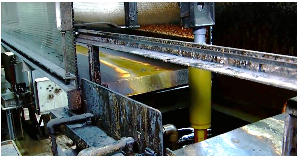
Obr. 13 Jedna z operací při chromování pístních kroužků – trn s kroužky při pasivaci po tryskání (hydrofíniši). Jako pasivační roztok se používá roztok \text{Cr6}^+ o nízké koncentraci (Buzuluk Komárov, a. s.) [20], [25]
