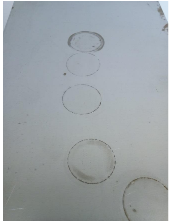
Obr. 47 Viditelné stopy koroze na vzorku z oceli 11 523
