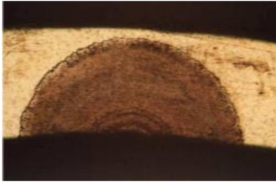
Obr. 22 Lokální odzinkování mosazi ve vodě – příčný řez [27]
