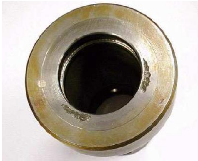
Obr. 20 Štěrbínová koroze příruby pod těsněním [27]
