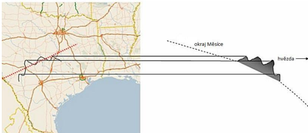
Obr. 1.5: Geometrický průběh tečného zákrytu [12]
