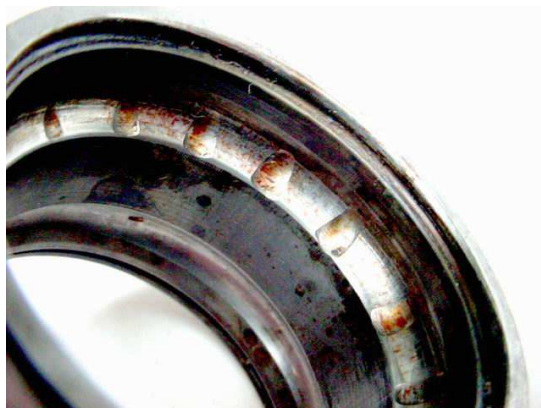
Obr. 2.7: Kroužek valivého ložiska poškozený vibracemi [11]
