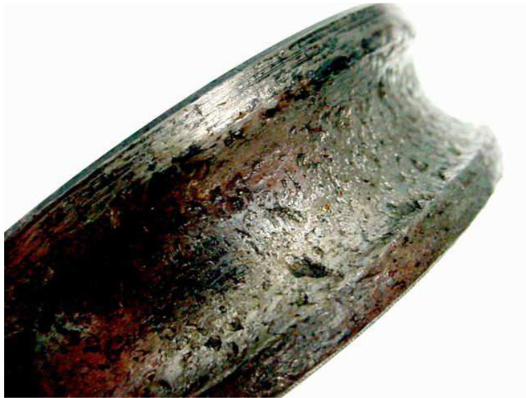
Obr. 2.1: Silně poškozený kroužek valivého ložiska [11]
