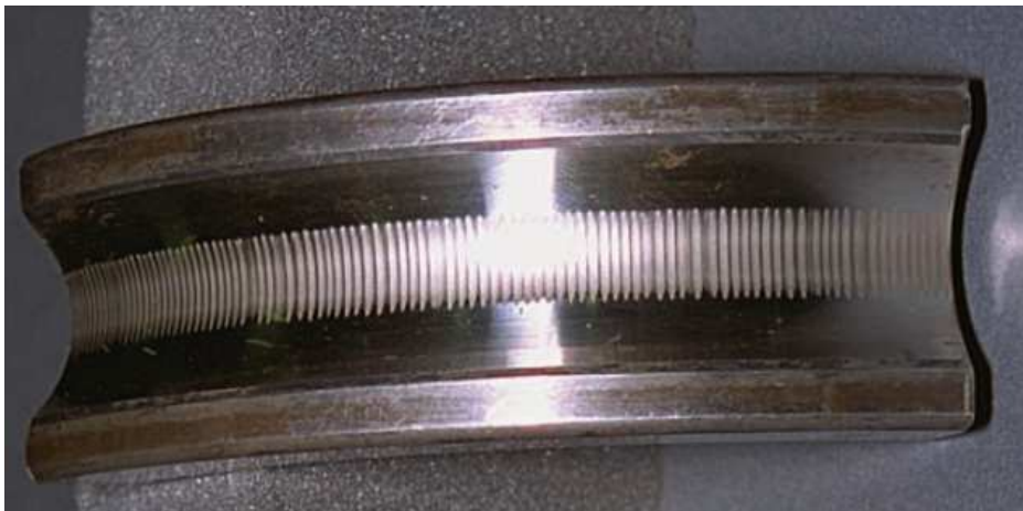
Obr. 2.9: Typický vzor vznikající na kroužku valivého ložiska při poškození el. proudem (tzv. fluting) [13]
