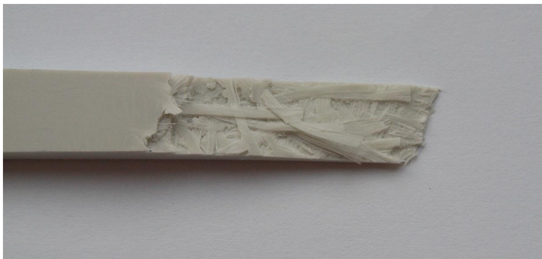
Obr. 11: Vzorek přeražený Charpyho kladivem
