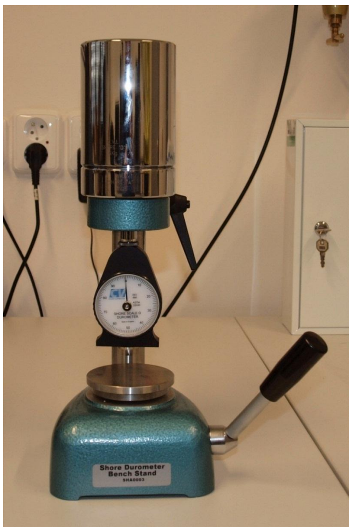
Obr. 13: Měřicí přístroj „Shore Scale D durometr“ pro měření tvrdosti povrchu
