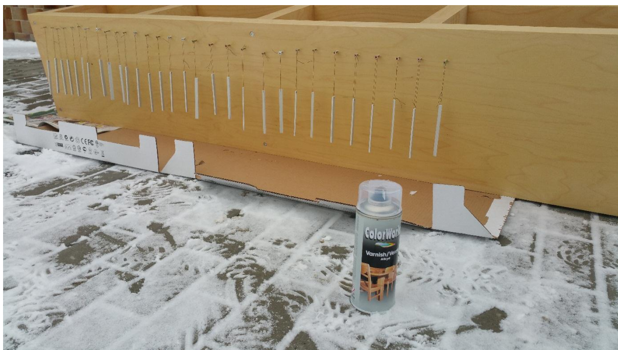
Obr. 7: Nanášení UV stabilizátoru na vzorky
