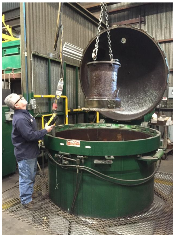
Obrázek 3: Pracovník firmy Sloan Electromechanical Service & Sales umísťuje přípravky do vakuové komory. Převzato z [9].
