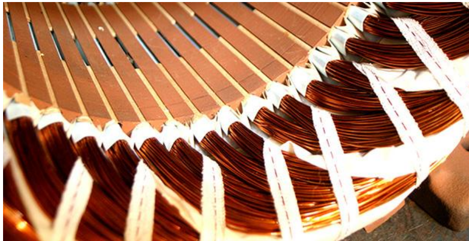
Obrázek 4: Izolace vinutí elektrického stroje pomocí Nomexu®. Převzato z [15].
