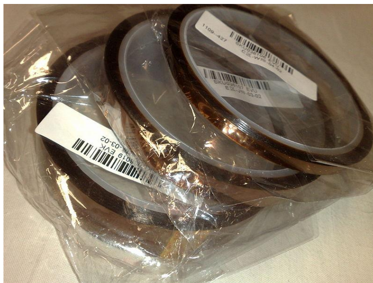
Obrázek 5: Izolační pásy vyrobené z Kaptonu®. Převzato z [17].
